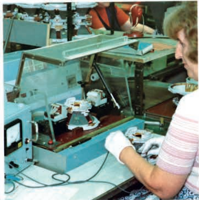
Elektrischer Prüfplatz für Ablenkeinheiten
