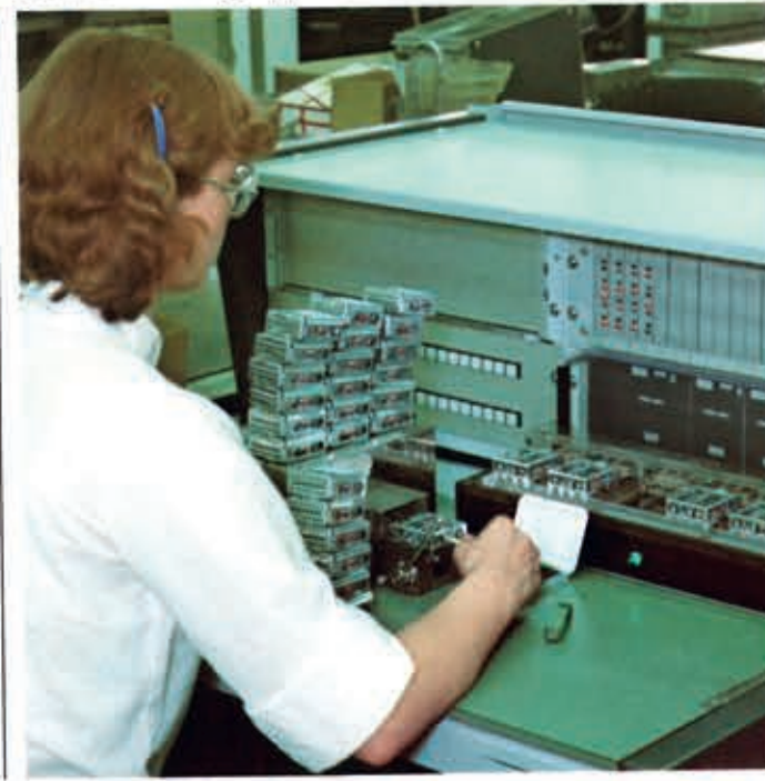
Einstellen und Abgleichen von elektrischen Baugruppen (Units)
