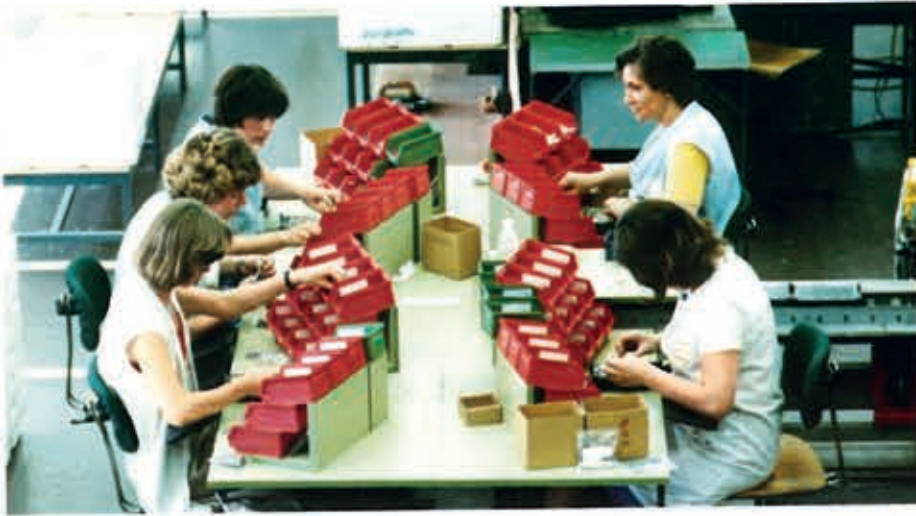
Produktbereich Tuner: Montage der Kanalwähler (Tuner) in Gruppenarbeit
